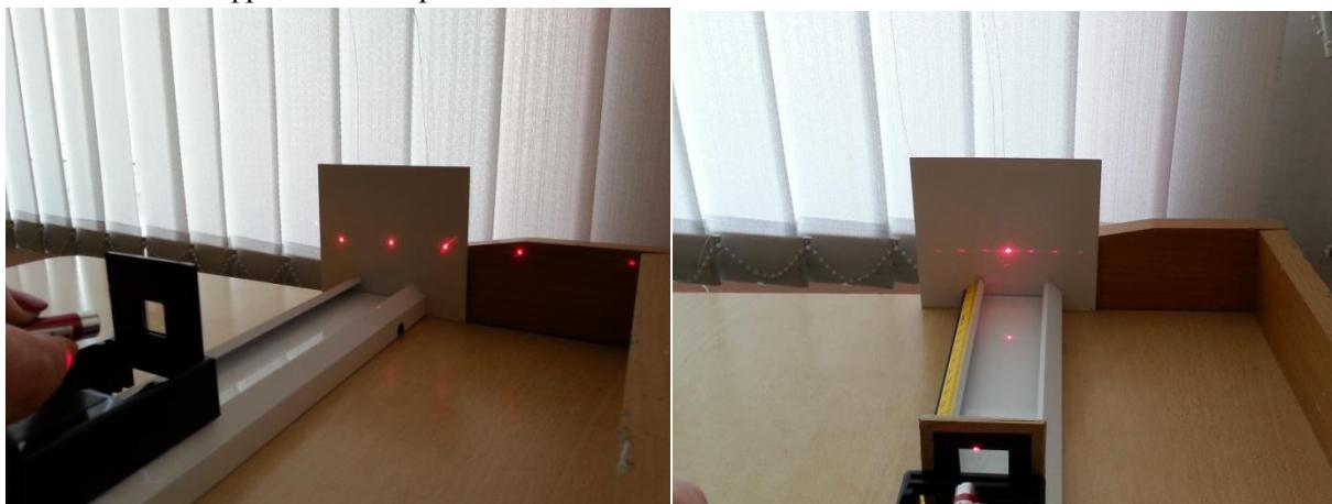
**Задание №2«Сравнение дифракционных спектров от монохроматического света при изменении расстояния от решетки до экрана и источника света»**
