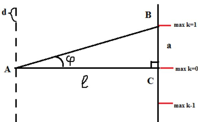
Вспоминаем формулу дифракционной решетки:  $d \cdot \sin\varphi = k \cdot \lambda$ . Так как при малых углах  $\sin\varphi = \tan\varphi \Rightarrow d \cdot \tan\varphi = k \cdot \lambda$ . Из прямоугольного треугольника ABC  $\tan\varphi = \frac{a}{\ell} \Rightarrow \frac{d \cdot a}{\ell} = k \lambda$
